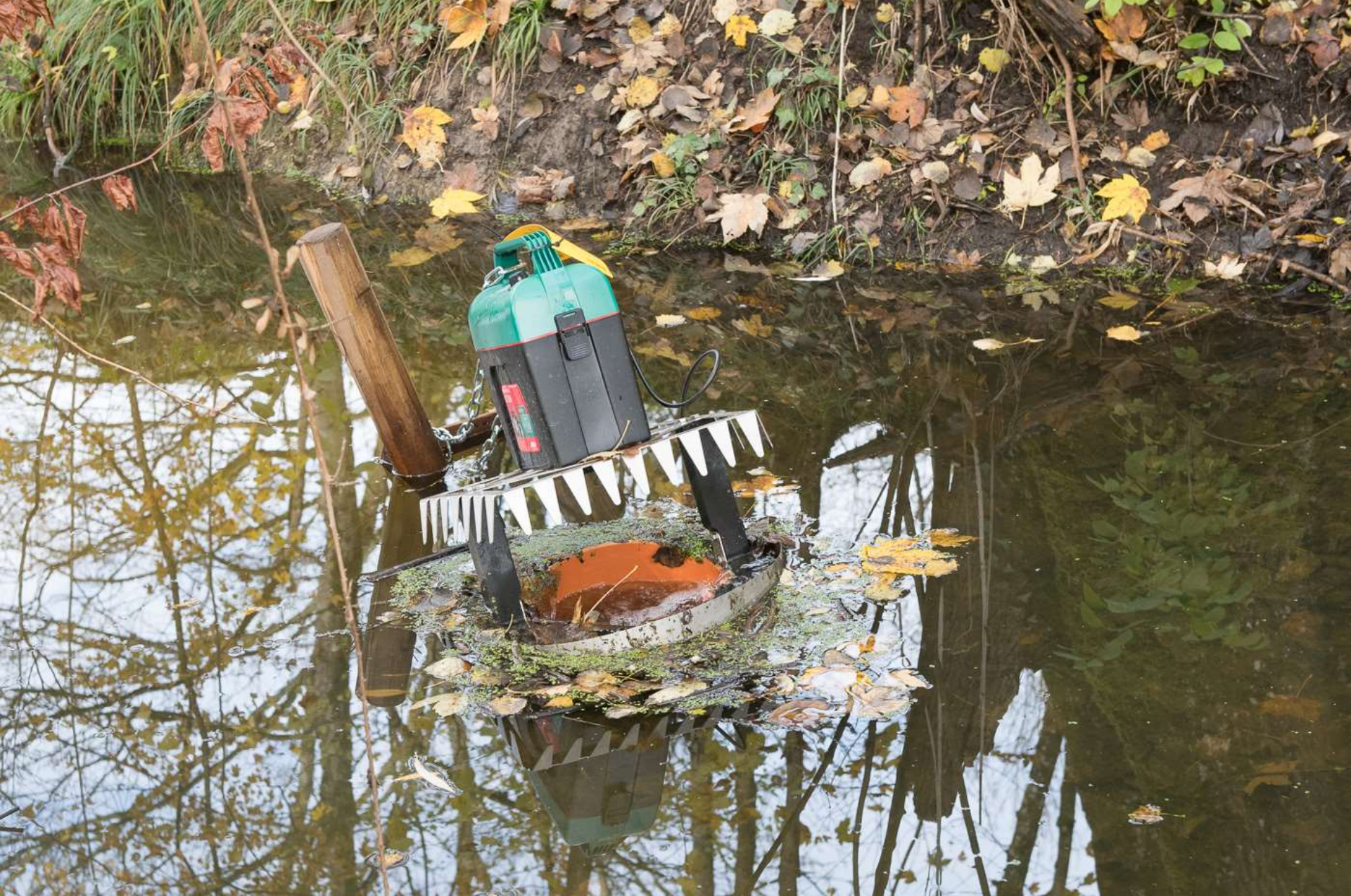
„Bibergator“ (Dammdrainage mit Strom statt Korb)
